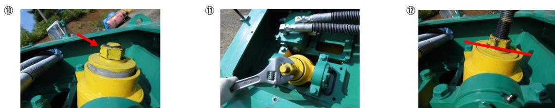
調整後にボルトヘッドを右へ締め込みます(⑩)。締め込みは外側ケースと高さと同じになるように締め込みます(⑫)。最後にカバー、使用しない調整板を定位置に戻し完了です。
