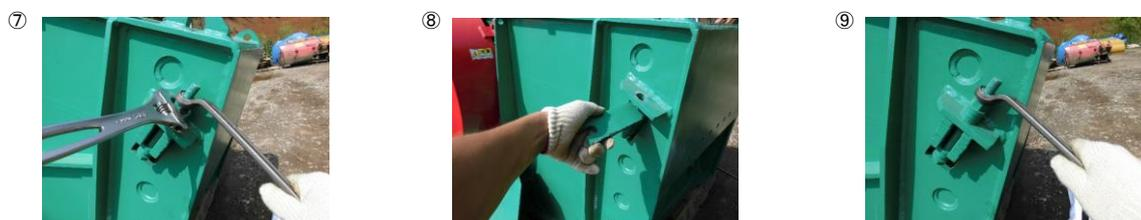
調整板差込部分のボルトを緩めて取外します(⑦)。調整板を差し込みます(取り外す)(⑧)。アジャストバーを差し込み、追加する事で排出口の幅は小さくなり、バーを取り外すことで出口幅は大きくなります。調整後、再度ボルトを通し締め付けます(⑨)。
