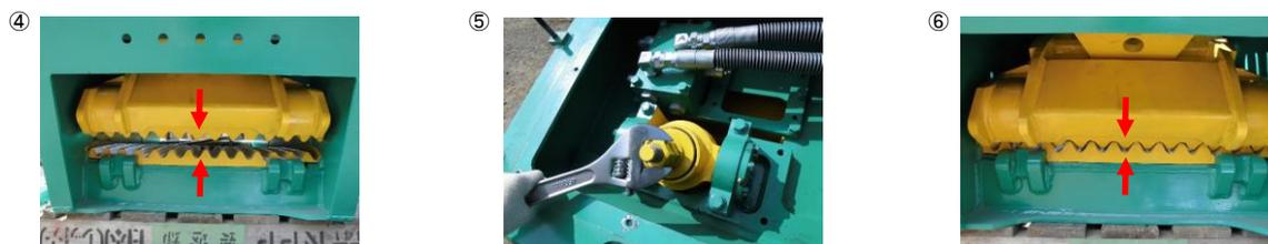
現状を確認し刃の開口部分を確認してください(④)。カバーを外し、中央部分にあるボルトヘッドを左回転で緩めます(⑤)。排出口の刃がかみ合うくらいまで緩めます(⑥)。
