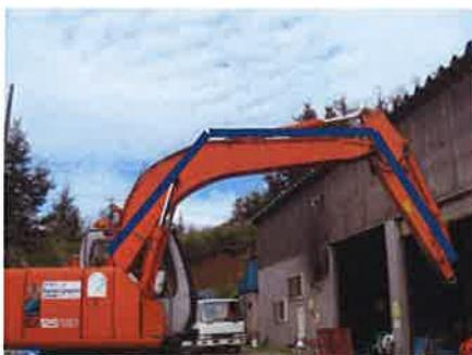
この機種では油圧配管のほか、トング、カッター部の開閉は電気制御にて操作します。アタッチメントより出ている配線をバックホーのアームを伝いキャビンまで繋いでください。キャビン天井蓋等を利用し写真の通り配線します。主となる電源はバックホー後方のバッテリーと繋ぎ、電気を引いてください。操作レバーを専用のボタン付きレバーに取り換えて、ください。
