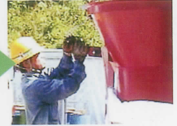
瞬作の楽に外せる治具でフレコンバッグを外し吊り上げて行程完了
